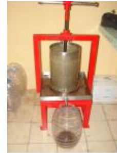
La masa o pasta de aceituna obtenida en el molino se coloca en la prensa con objeto de favorecer la salida del aceite
