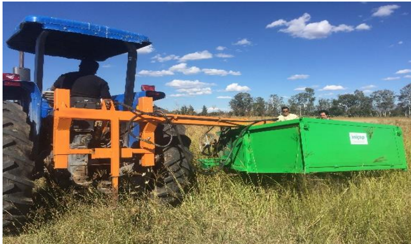
Cosecha mecanizada de semilla de pastos
