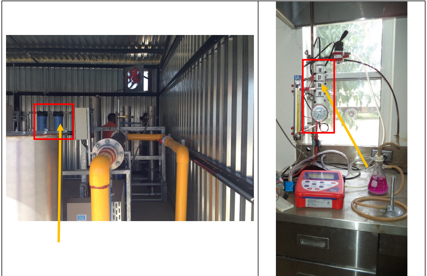
Figura 1. a) Tecnología actual: carbón activado y sosa caustica. b) Reactor empacado con nanopartículas de ferrita.
